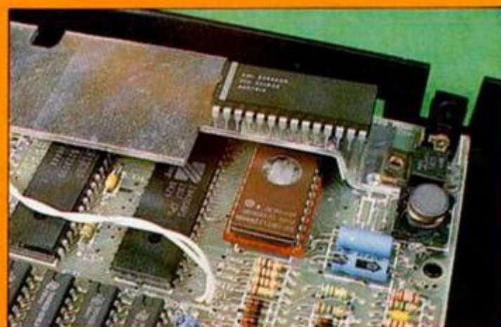
ROM y EPROM son intercambiables a voluntad gracias al zócalo colocado en el antiguo emplazamiento de la ROM.
