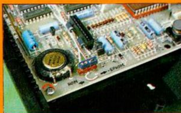
ROM y EPROM son intercambiables a voluntad gracias al zócalo colocado en el antiguo emplazamiento de la ROM.
