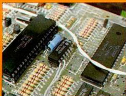
Detalle de la colocación del 74LS04 encima del 74LS32 para obtener la alimentación del primero.
